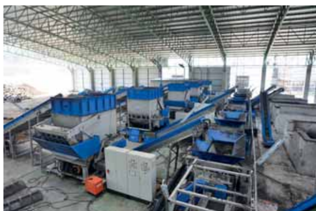
ZXS-T和ZTTS撕碎机组成的RDF轮胎回收线
